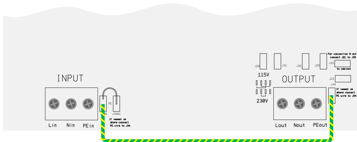
Aarding AC-ingang is verbonden met aarding AC-uitgang wanneer het vaartuig uit het water (op het land) is tijdens de winter of voor onderhoud.
